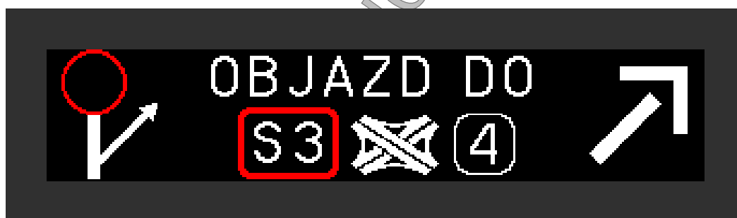
Rys. 4.1.3.10. Przykład komunikatu na TZA-DP informującego o przekierowaniu na trasę alternatywną
