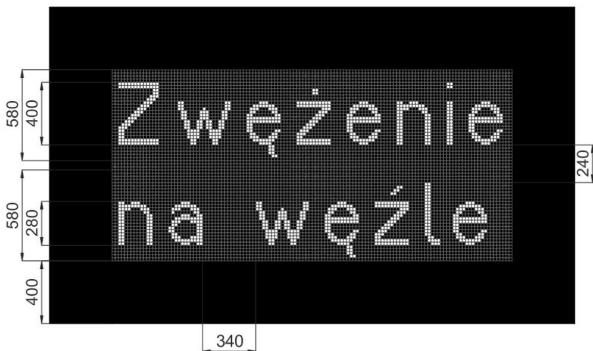
Rys. 4.4.2.9. Przykład układu tekstu z wykorzystaniem małych liter oraz odpowiedniej interlinii i marginesu dla czcionki z grupy liter E przy zastosowaniu odstępów między pikselami 20 mm
