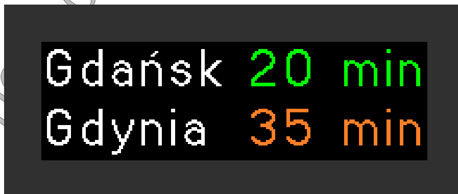
Rys. 4.4.3.1. Przykład układu komunikatu z wykorzystaniem różnych barw dla czcionki z grupy liter E
