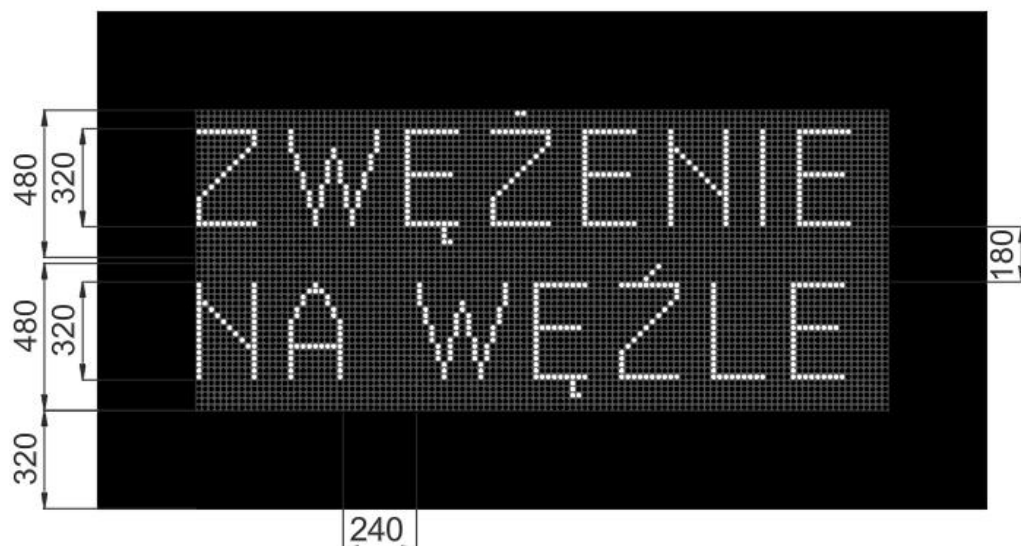
Rys. 4.4.2.12. Przykład układu tekstu z wykorzystaniem wielkich liter oraz odpowiedniej interlinii i marginesu dla czcionki z grupy liter D przy zastosowaniu odstępów między pikselami 20 mm
