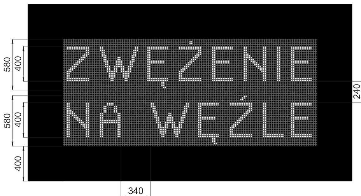
Rys. 4.4.2.10. Przykład układu tekstu z wykorzystaniem wielkich liter oraz odpowiedniej interlinii i marginesu dla czcionki z grupy liter E przy zastosowaniu odstępów między pikselami 20 mm
