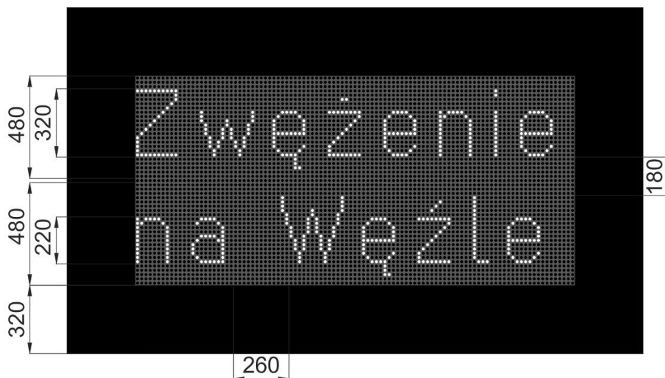
Rys. 4.4.2.11. Przykład układu tekstu z wykorzystaniem małych liter oraz odpowiedniej interlinii i marginesu dla czcionki z grupy liter D przy zastosowaniu odstępów między pikselami 20 mm
