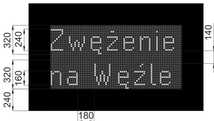
Rys. 4.4.2.13. Przykład układu tekstu z wykorzystaniem małych liter oraz odpowiedniej interlinii i marginesu dla czcionki z grupy liter C przy zastosowaniu odstępów między pikselami 20 mm
